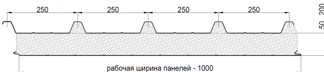
Рисунок 6. Геометрия кровельной сэндвич-панели (ПКТ Z)
