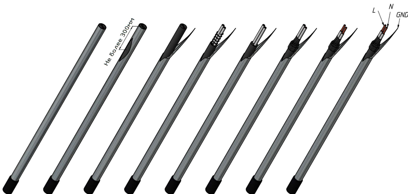
Рисунок 12. Подготовка отрезка ПЭНа к подключению
