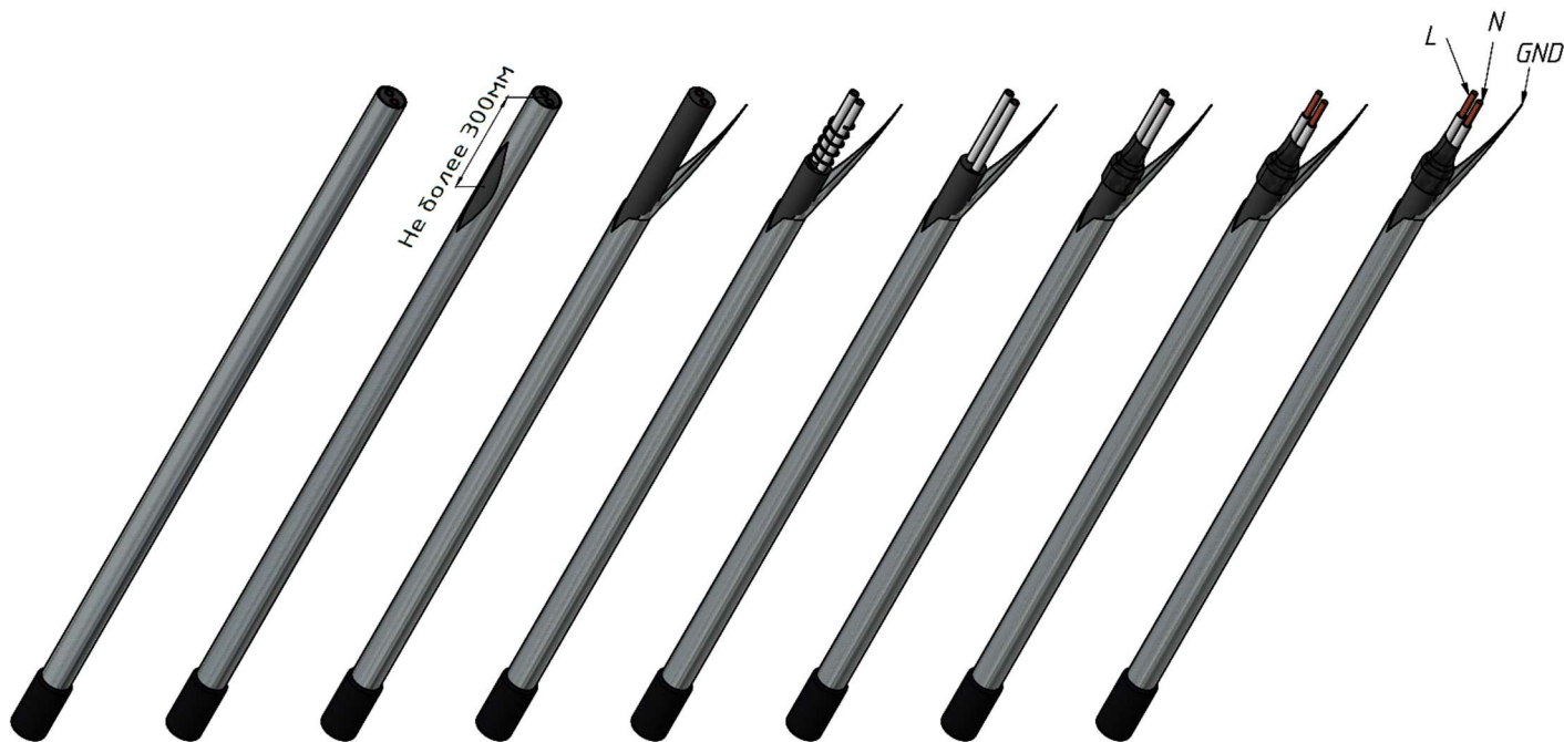
Рисунок 6. Подготовка отрезка ПЭНа к подключению
