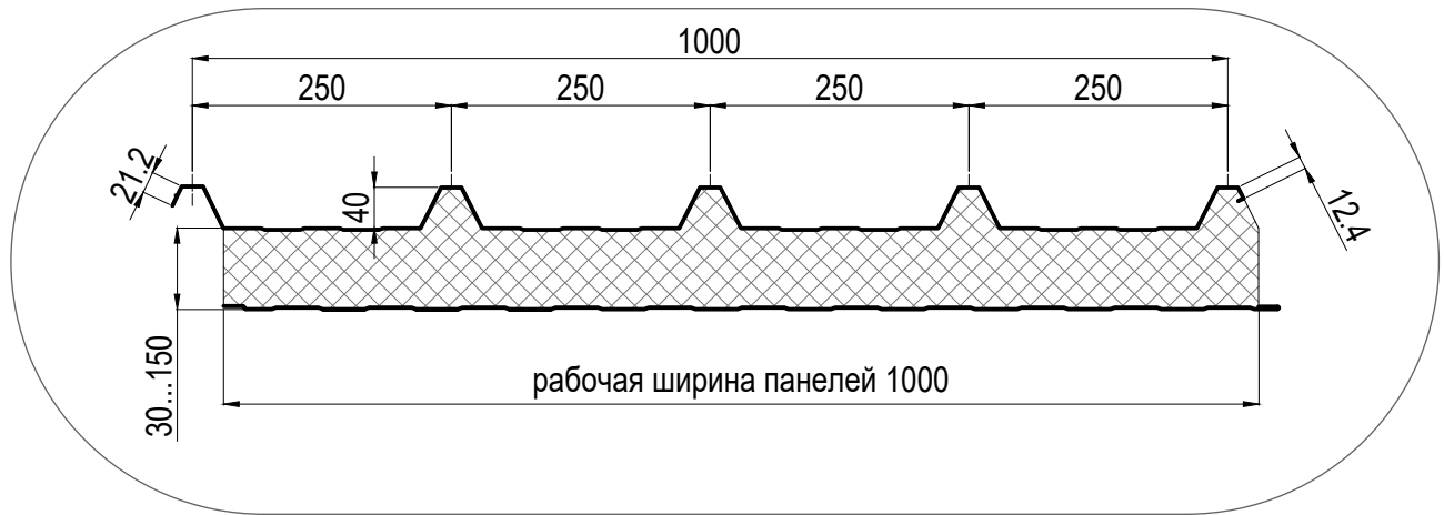
Рисунок 24. Геометрия кровельной сэндвич-панели со стандартным замковым соединением
