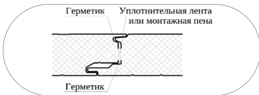
Рисунок 20. Геометрия стеновой сэндвич-панели с замковым соединением SECRET FIX (ПСТ SF)
